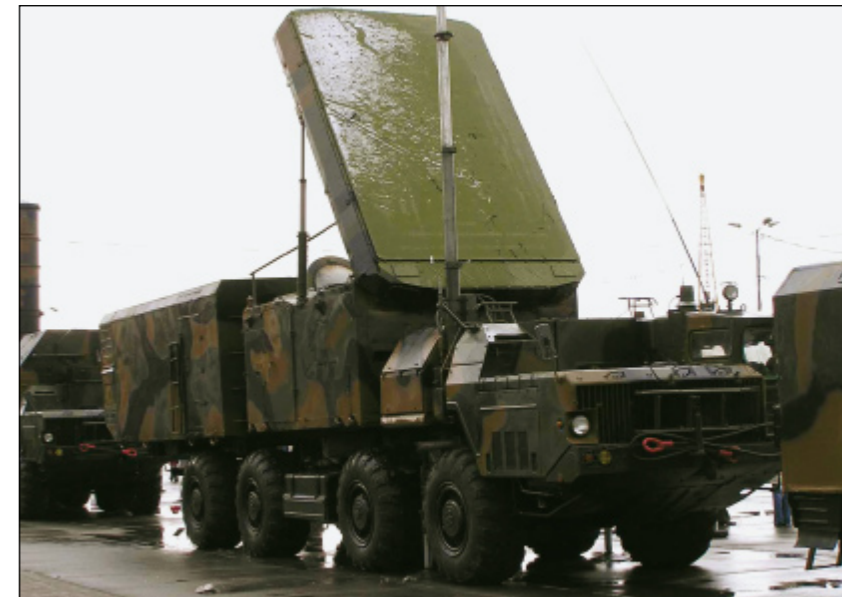
Sledovací a naváděcí radiolokátor 30N6E
