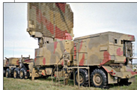
Radiolokátor 64N6E s platformou F6E a F8E a s tahačem MAZ 79104
